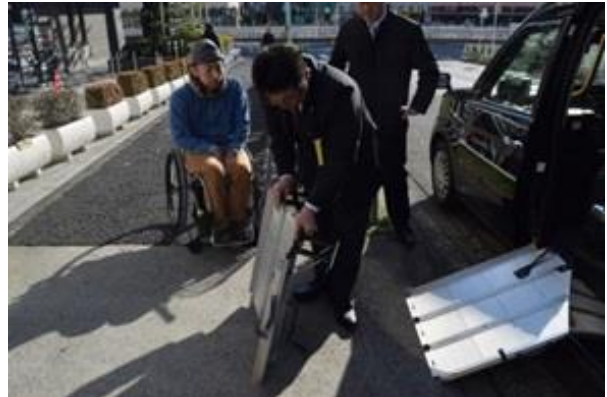
路上の傾斜に合わせて 車両へのアプローチを設置
